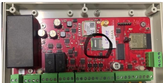
Рисунок 2 Контроллер TOUCH и терминал Micro Sim
